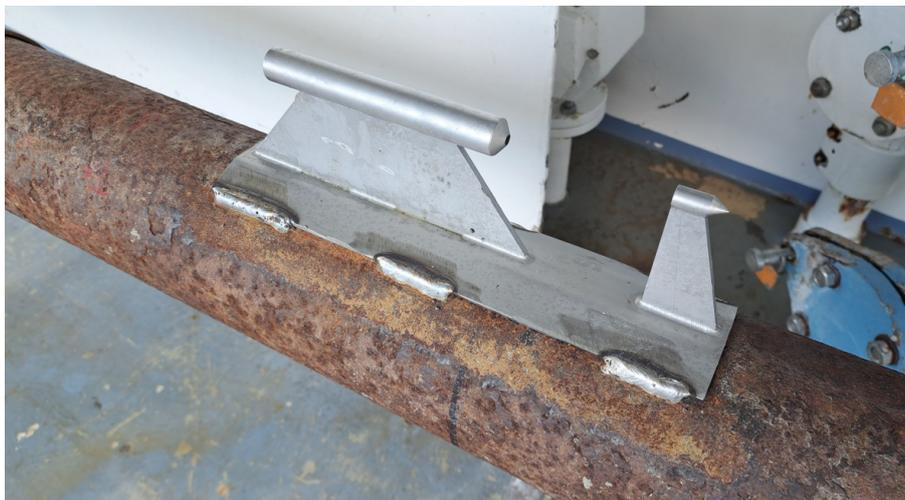
Carottier gravitaire avec emplacement pour sonde température
