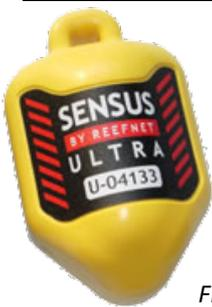
Les sondes du dispositif « Eaux souterraines » sont des capteurs autonomes qui enregistrent la température et la pression. Avant de les installer dans une grotte, les scientifiques paramètrent le temps entre chaque mesure. La **fréquence d'échantillonnage** correspond au nombre de mesures réalisées par unité de temps. Par exemple, une mesure toutes les 5 minutes.
