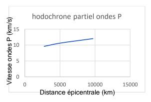
Augmentation de la vitesse de propagation des ondes P en fonction de la distance (donc de la profondeur du manteau).
