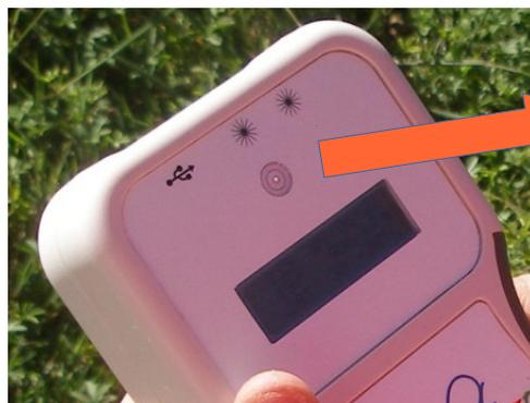
Le Soleil est au centre de la cible : le photomètre est pointé.
