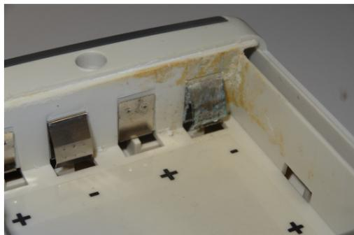
Lorsque votre photomètre n'est pas utilisé pendant un long moment, nous vous conseillons de retirer les piles. En effet, certaines marques de piles se dégradent avec le temps et abîment les contacts du boîtier.
