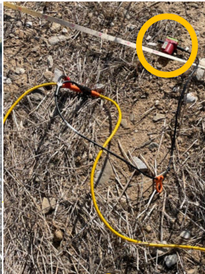
Détail d'un géophone relié au câble.
