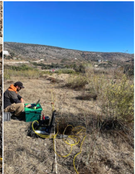
Les géophones sont liés à un ordinateur par le câble.
