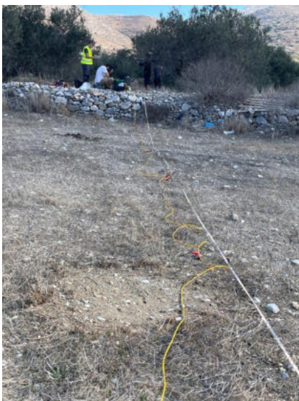
Ligne de géophones plantés dans le sol.
