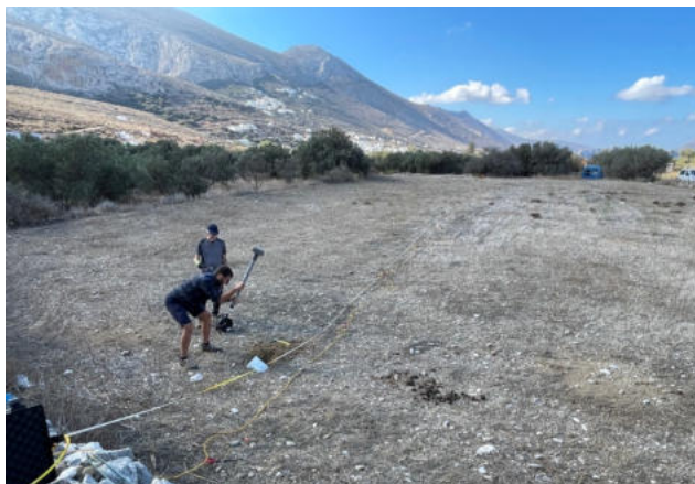
Un choc sur le sol est réalisé avec une lourde masse. Le choc génère des ondes qui se propagent et qui sont enregistrées le long de la ligne de géophones.
